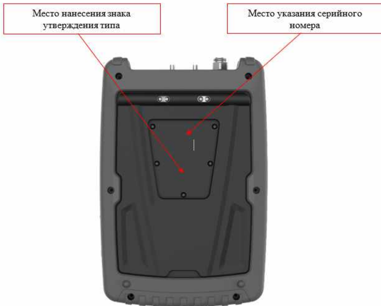
Рисунок 2 – Место нанесения серийного номера, идентифицирующего каждый экземпляр СИ; место для нанесения знака утверждения типа
