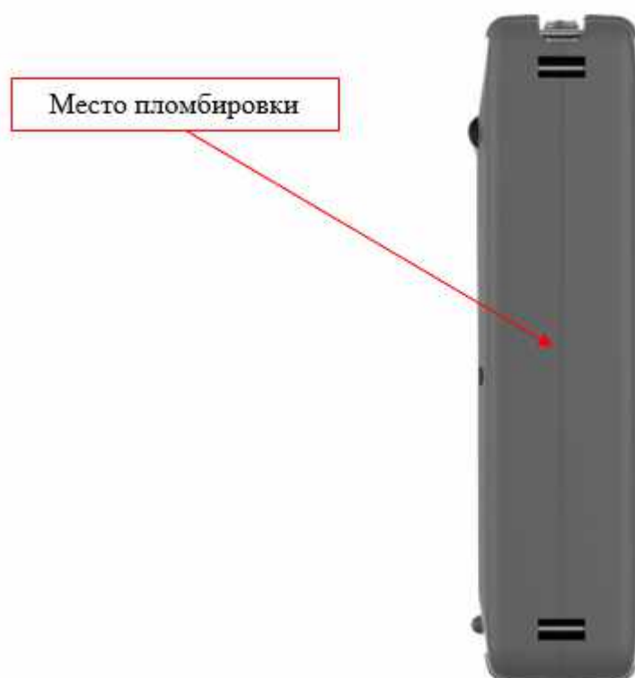
Рисунок 3 – Схема пломбировки от несанкционированного доступа
